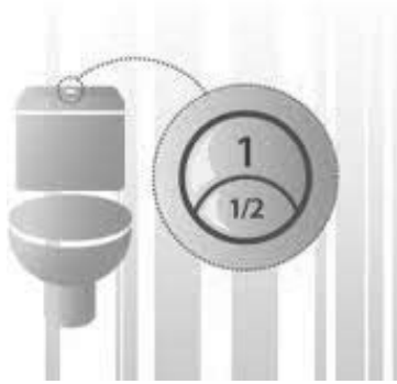
Depósito de doble descarga
