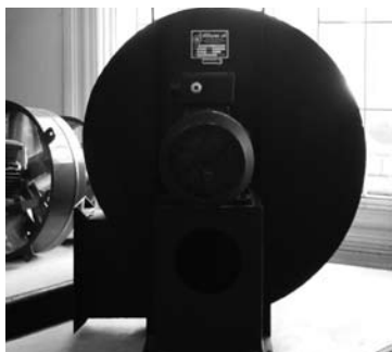
Extractor centrifugo sin fácil acceso para su limpieza
