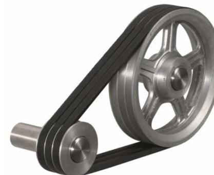
Pérdidas de energía por deslizamiento de correas (tensado insuficiente)
